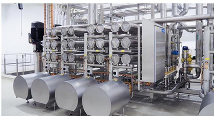
Stufen der RO/NF Anlage
