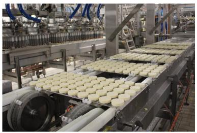
Die Greifköpfe legen die Käsestücke auf Gitterböden ab, auf denen diese dann die Salzung und Reifung durchleben. Bild: Alpenhain
