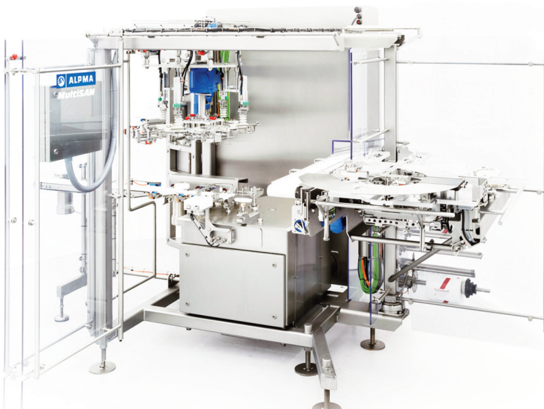
Traditionelle Faltverpackungsmaschine MultiSAN mit neuester Servotechnologie und einer Leistung von bis zu 80 Produkten pro Minute.
