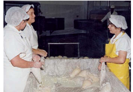
Traditionell erfolgt die Abtrennung des Käsebruchs von der Molke mittels Tüchern
