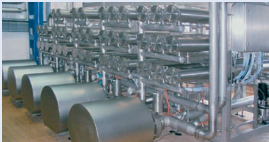
UF-Anlage zur Aufkonzentrierung von Magermilch in einer Käserei
