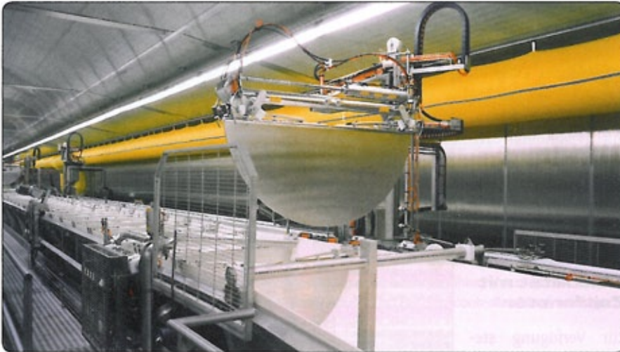
Im Koagulator laufen die Rührprozesse auch während des Molkenabzugs
