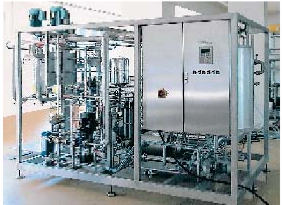
Mit Pilotanlagen werden in Käsereien Versuche zur Herstellung von partikuliertem Molkenprotein-Konzentrat durchgeführt, das dann gleich vor Ort zu Testzwecken eingesetzt werden kann.
