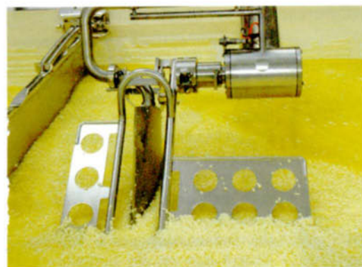
Axialrührer mit integrierter Molkeabsaugung
