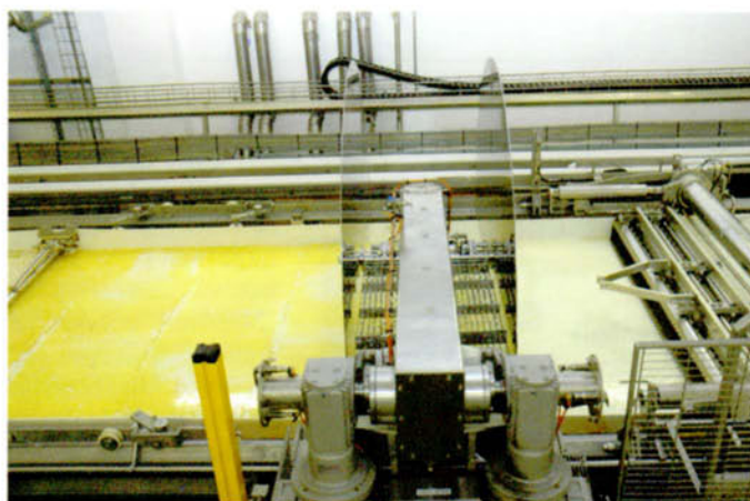
Platten begrenzen das Ausweichen des Bruchkuchens vor der Schneideharfe
