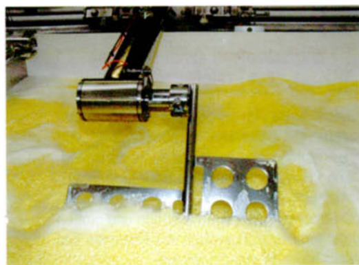
Intensive Bruchbearbeitung von kleinem, stabilem Bruchkorn mit Axialrührer für Schnittkäse
